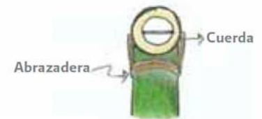
Conexión de correa de dos abrazaderas y tres perforaciones.
